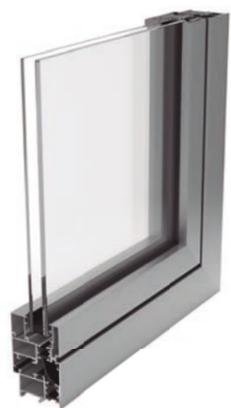
La série **F50 RPT** d'exlabesa propose de nombreuses possibilités pour tous vos projets grâce à des profils en rupture de pont thermique avec épaisseur de vitrage jusqu'à 38 mm. De nombreuses applications caractérisent cette série: fenêtres et porte-fenêtres 1 et 2 vantaux, ensembles composés par intégration, châssis sur allège, avec imposte ou fixes latéraux, châssis basculant, et à l'italienne.
