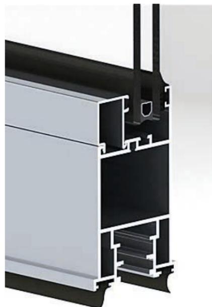
La Série F50 PL de portes Va et Vient en aluminium d'**exlabesa** est destinée au secteur tertiaire (magasins, halls d'immeubles, commerce, etc.). Le fonctionnement de cette porte sur pivot encastré permet l'ouverture simultanée ou indépendante, vers l'intérieur ou l'extérieur de chaque vantail. L'espace de 16 mm entre le dormant et l'ouvrant est obturé par une double barrière de joints en EPDM.
