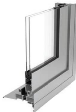
Conçue pour répondre aux normes les plus exigeantes, **C800 RPT** est la série coulissante avec rupture de pont thermique qui fait bénéficier d'un niveau d'isolation thermique exceptionnel avec un dormant de 83 mm disponible en deux version rails rapporté et rails fermé et une polyamide isolante de 25 mm permettant d'optimiser les performances énergétiques du bâtiment. Son installation garantit un confort en toutes saisons et s'inscrit pleinement dans une démarche d'économie d'énergie.
