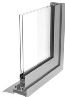
L'assemblage en coupe périmétral des ouvrants de la série **C700** lui offrent un esthétisme toujours plus attractive avec un épaisseur de vitrage jusqu'à 20 mm . L'esthétique contemporain des ouvrants s'adapte avec le dormant périmétral de 75 mm en ligne droite rails rapporté ainsi qu'avec le dormant traditionnel (galbé) rails fermé.
