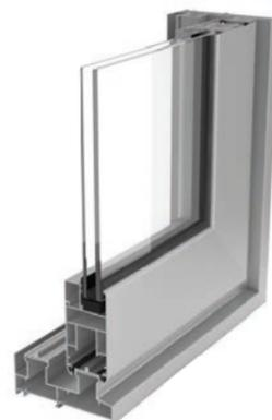
La série **C1200 Elevable** nous offre un design aux grandes dimensions grâce au mécanisme du levage du coulissant qui nous permet d'escamoter les roulettes de guidage lors de la fermeture du vantail. Ce système composé de train de roulement qui supporte 350 kg par vantail et qui apporte un réel confort et une manœuvre aisée malgré la dimension exceptionnelle des vantaux.
